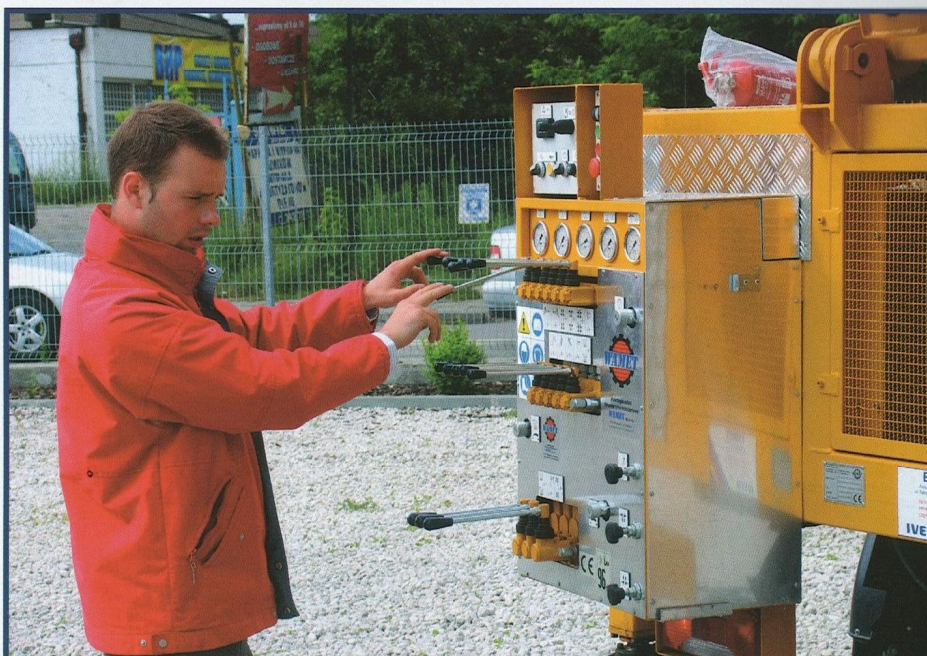
Obsługę wiertnicy umożliwi czytelny i łatwy w obsłudze pulpit sterowniczy zawieszony na tyle zabudowy.
