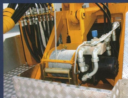
Potężna wciągarka ma stalową linę o średnicy 9 mm i długości 50 m.
