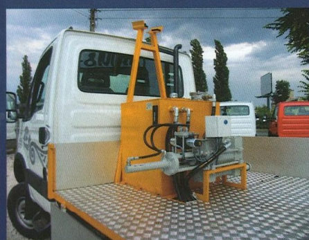
Duży zbiornik oleju oraz wydajną pompę hydrauliczną umieszczono w przedniej części skrzyni, tuż za kabiną, między innymi dla lepszego rozłożenia nacisków na osie.
