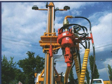
Głowica wiertnicy to wyrafinowany technicznie podzespół napędzany hydraulicznie. Na poprzeczce umieszczonej w górnej części masztu są dwie najsilniejsze oświetlające pole pracy, co umożliwia pracę także w nocy.
