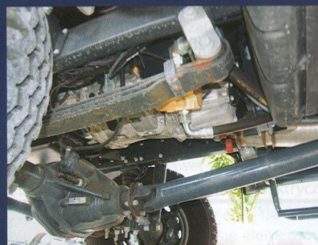
Auto wyposażono w dwie przystawki odbioru mocy. Jedną z nich służy do napędu pompy.
