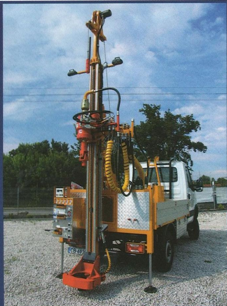
Maszt wiertnicy stawiany jest za pomocą hydraulicznych siłowników. Hydrauliczne są także podpory stabilizujące urządzenie umieszczone w tylnych narożnikach zabudowy.
