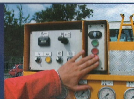
Silnik pojazdu i PTO można włączać nie tylko z kabiny, ale także z zewnętrznego pulpitu.
